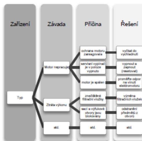
Diagram 1 – možné závady a jejich odstranění
