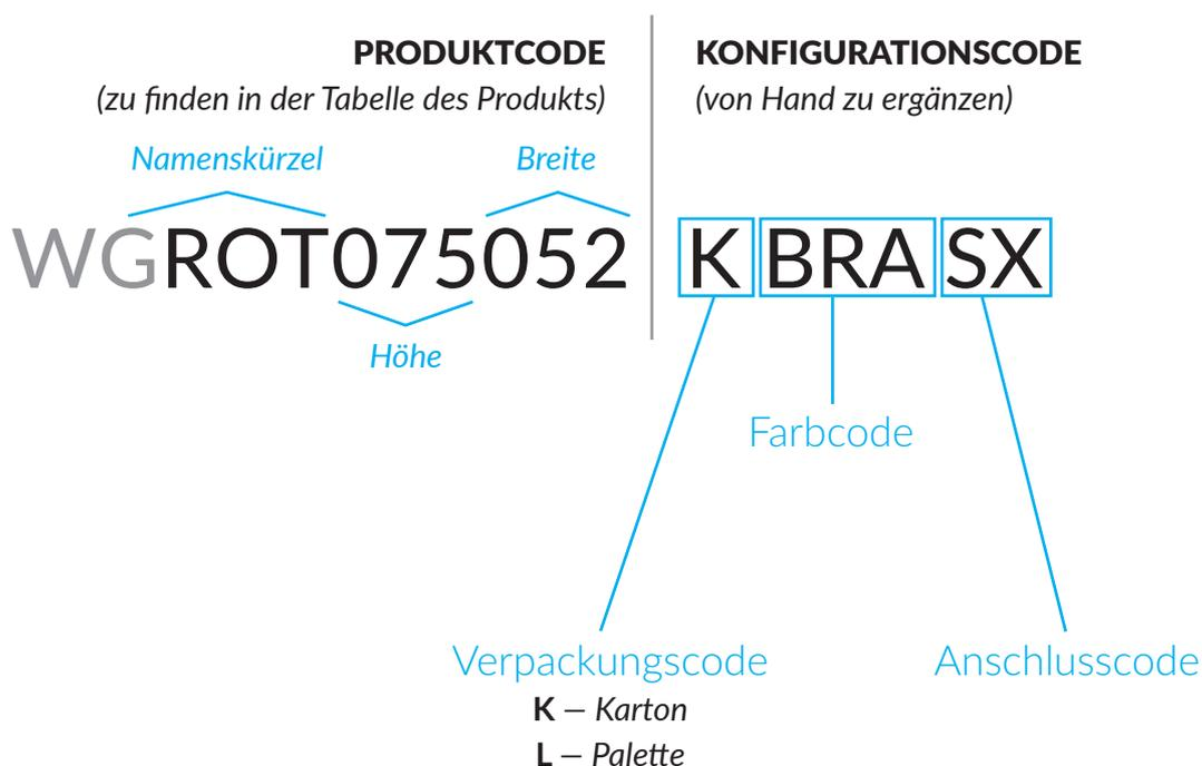
WG – Wasser- oder Kombiheizkörper zum Anschluss an eine Zentralheizung
