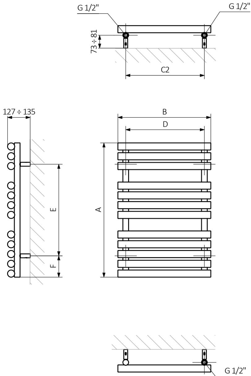
A – Höhe B – Breite C1-C5 – Anschlussabstand D – horizontaler Wandhalterungsabstand E – Vertikaler Wandhalterungsabstand F – Abstand von der Achse der unteren Wandhalterung bis Unterkante des Kollektors
